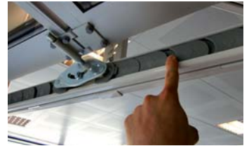
Carterizzazione delle guide di scorrimento/Sliding tracks cover/Schutzabdeckung für Laufschiene
